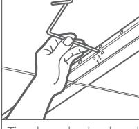
**Instale las T transversales.** Inserte las lengüetas en las ranuras en la T principal. Donde dos T transversales ocupen la misma ranura, inserte la segunda T transversal a la izquierda de la primera T transversal.
